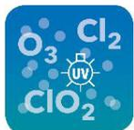
Zur Desinfektion kommen die Zugabe von Chlor, Chlordioxid, Ozon (chemische Desinfektion) oder die UV-Behandlung (physikalische Desinfektion) in Frage. Dabei ist die Ozonierung zumindest in Deutschland nicht als alleiniges Desinfektionsverfahren zugelassen.
